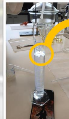
Fig.3 – Solução aquosa de cloreto de cálcio 2% (m/v) e gelificação
