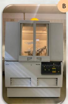
Figura 2: A- microscópio eletrónico de varrimento B- difratómetro de raios X automático
