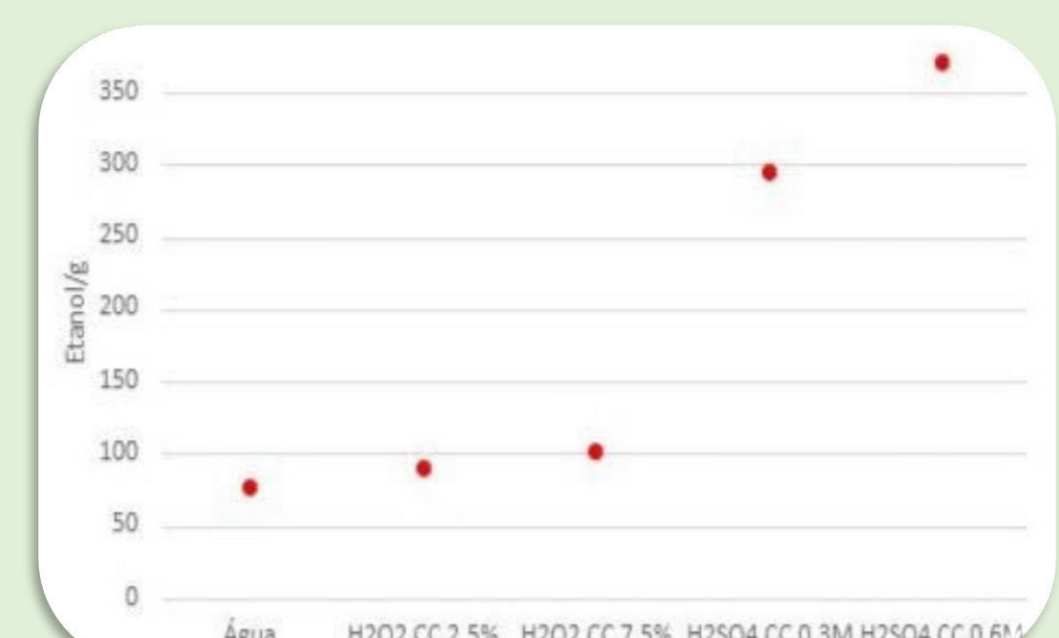
Fig.9- Quantidades de Etanol que poderão ser produzidas a partir da quantidade de açúcares redutores presentes em cada solução. A solução que contém água funciona como solução controlo.
