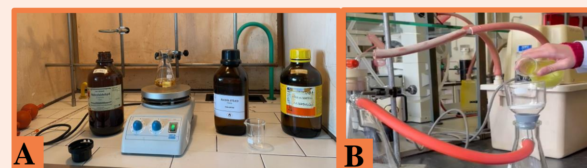
Fig. 5 - A. Reagentes utilizados (etanol; salicilaldeído; etilenodiamina). B. Montagem da filtração à tampa
